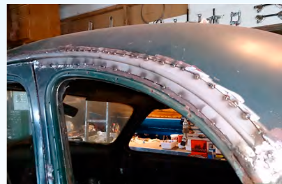
Sigmund er flink til å sveise rust etter tre restaureringar. Her frå 2015 og den verste jobben på 1940 Buick'en. Å sveise inn nye drypplister på begge sider av taket, kapp ut frå eit anna tak.
