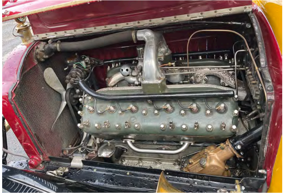
Om man skulle operere i luksusklassen var estetikk like viktig i 1916 som i dag, selv for en motor som normalt lå skjult under panseret. Packard twin six er egentlig to rekkeseksere som er satt sammen i V-form og yter 88 hk, noe som gjør det spennende når man har stor, tung og sterk bil med kun bremses på bakhjulene.
